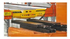
穿梭车立体库作为一种智能化密集仓储设备,具有动态移载的特点,运用在自动化物流系统中,可使不同工位之间物料的输送布局更加紧凑、简捷,由此提高货物的传送效率。在电控系统控制下,堆垛机把货物提升到指定高度并将其放置在各输入工位,再由穿梭车通过认址方式精确定位于输入工位,接收物料后自动进行平面运输,主要应用于物流系统中单元物料的高速往复输送,具有高度的自动化和灵活性。
