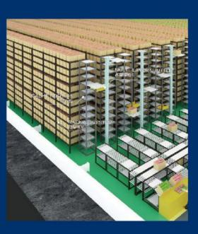
该系统是一种集合"货到人"分拣和密集存储为一体的全新自动 化存储模式,相比传统的 MINILOAD 系统更为先进、高效的适用于件 箱物流的自动 化存储。
